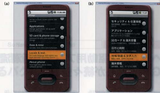
図2 国際化に対応 言語設定メニューで日本語を選ぶと、再起動することなく画面表示が日本語になる。(a) 標準の英語表示モード。(b) 日本語表示モード。図はエミュレータでの動作。
